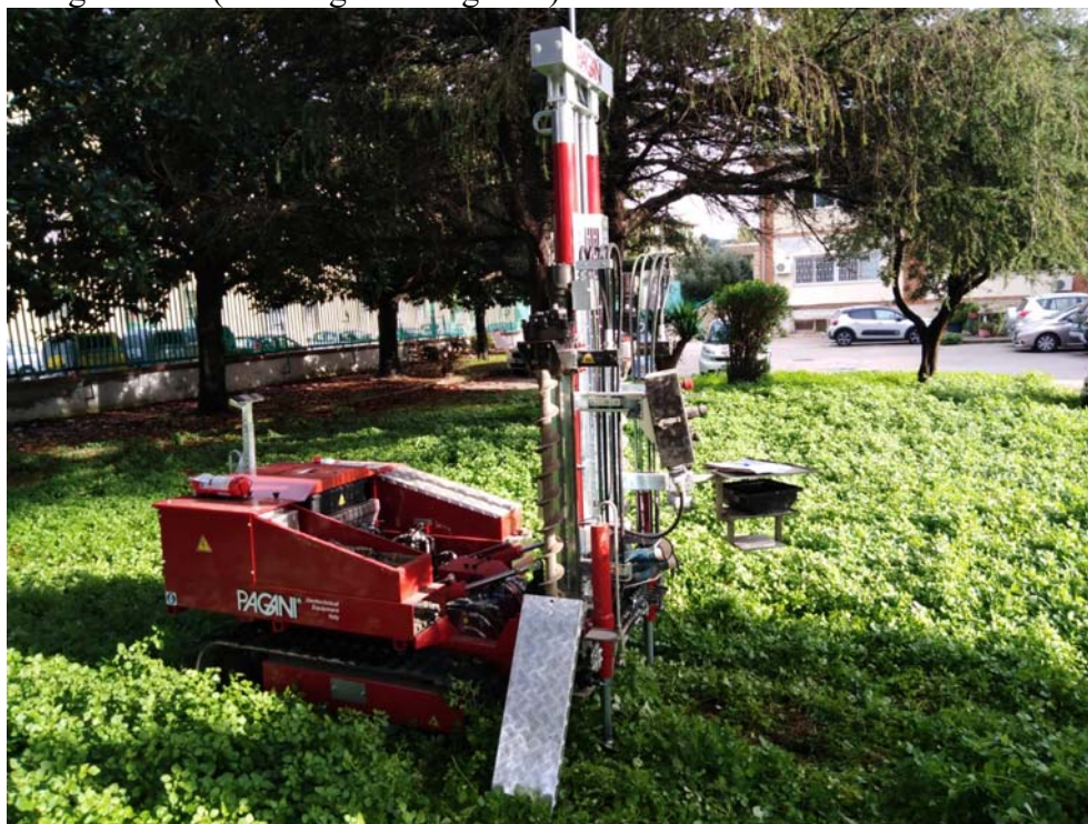
Postazione prove penetrometrica dinamica pesante DPSH 01
